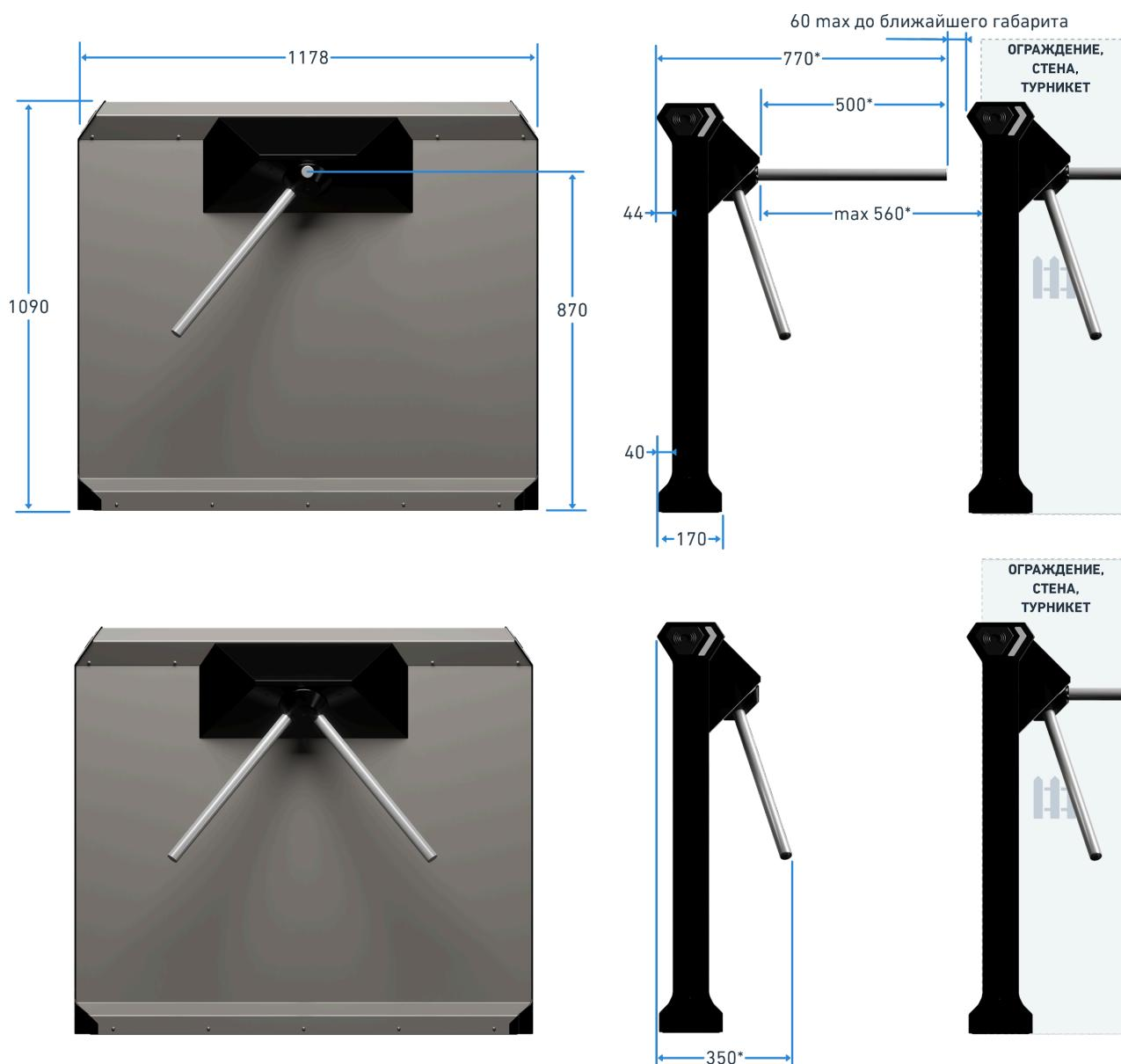
\* По индивидуальному согласованию с производителем, турникет может быть укомплектован специально изготовленными преграждающими планками рабочей длиной более 500 мм до 700 мм.
