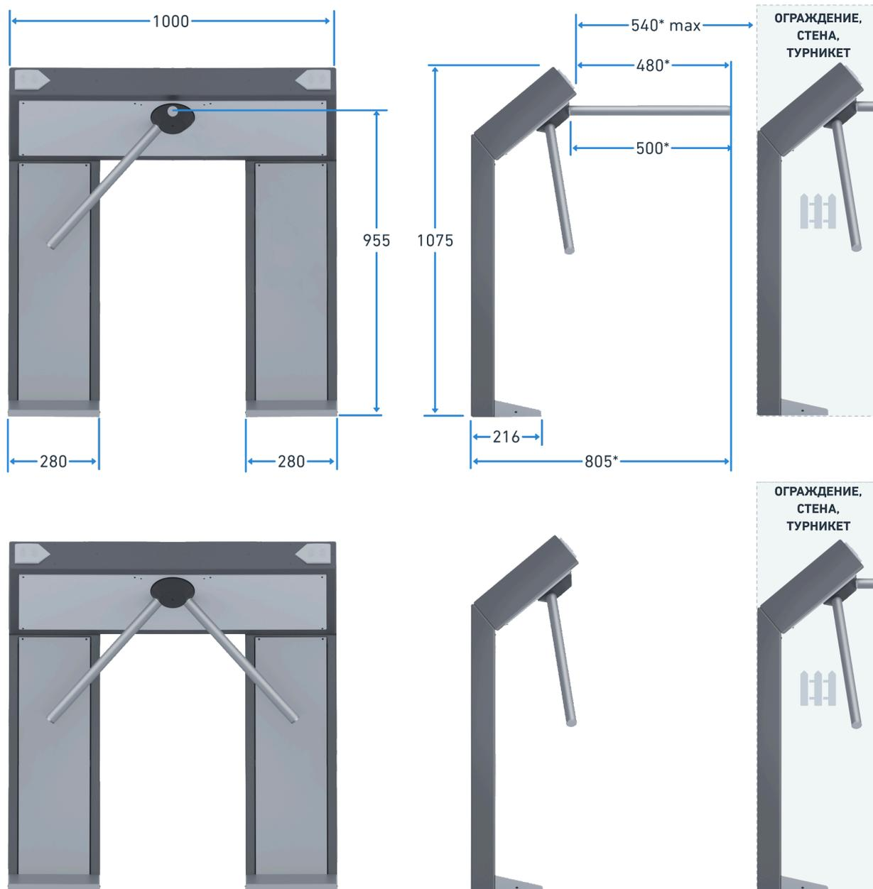
\* По индивидуальному согласованию с производителем, турникет может быть укомплектован специально изготовленными преграждающими планками рабочей длиной более 500 мм до 700 мм.
