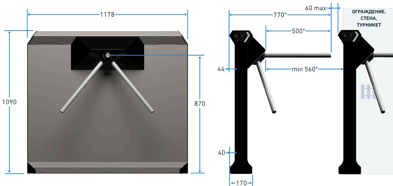
\* По индивидуальному согласованию с производителем, турникет может быть укомплектован специально изготовленными преграждающими планками рабочей длиной более 500 мм до 700 мм.
